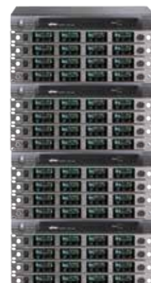
Bild 3C: Sechzehn MIPRO ACT-747 4-Kanal Empfänger die über vier AD-708 Antennensignalverteiler versorgt werden.
