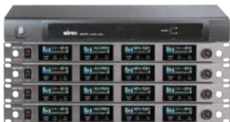
Bild 3A: Vier MIPRO ACT-747 4-Kanal Empfänger die über einen AD-708 Antennensignalverteiler versorgt werden.
