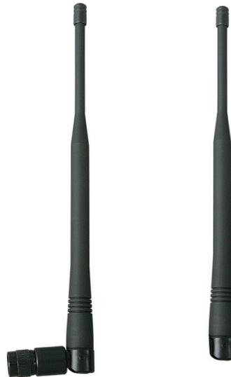
Die AT-20 ist eine Breitband,  $\lambda/2$  Stabantenne mit kugelförmiger Empfangscharakteristik. Die Impedanz beträgt 50 Ohm. Die AT-20 kann direkt auf die TNC-Eingangsbuchse der drahtlosen Empfänger geschraubt werden. Die Antenne ist für Nahanwendungen geeignet.
